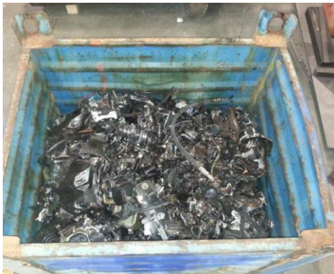
Outputmaterial aus T-Break
